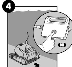
Le nettoyeur se met à fonctionner jusqu'à ce qu'il complète le cycle de nettoyage.
