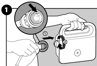
Conecte el cable flotante a la fuente de alimentación.
