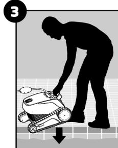
Coloque el limpiador en la piscina. Suelte el limpiador de piscina y deje que se sumerja en el fondo de la piscina. Asegúrese de que el cable flotante no está obstruido.
